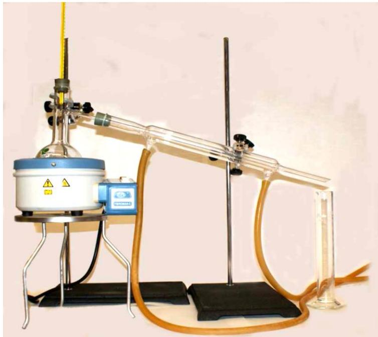
Fig. 1. Sistema de destilación
